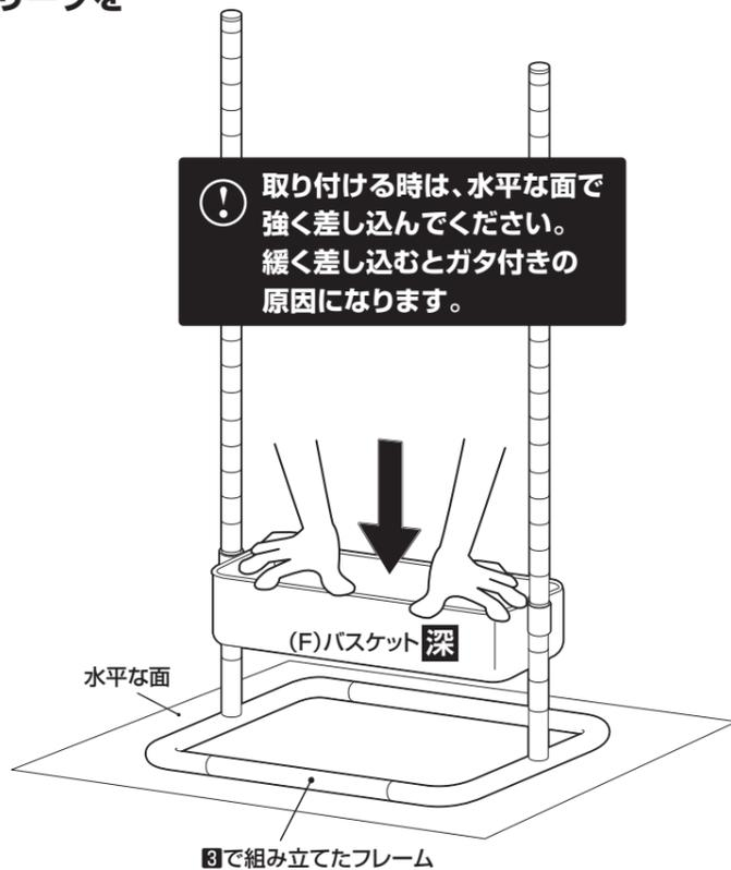
**5** 組み立て手順④の要領で、組み立てた本体にバスケットを取り付けていきます。
