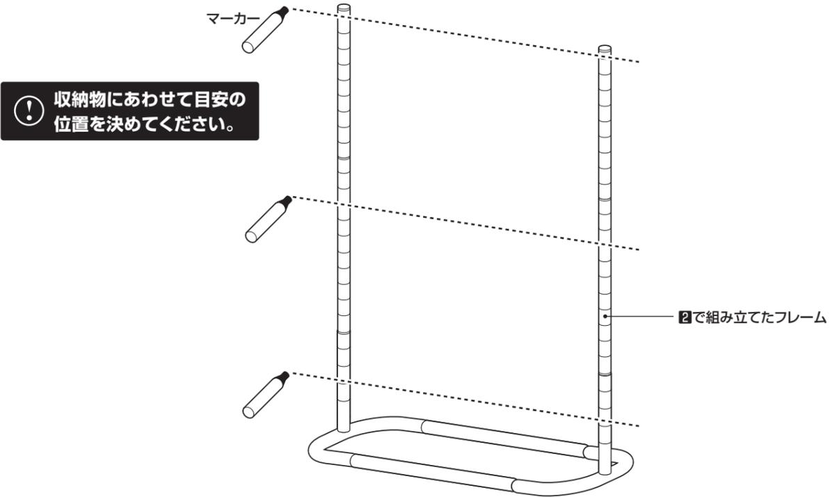
**4** バスケットの取り付け位置に、テーパースリーブをはめてからバスケットを取り付けます。
