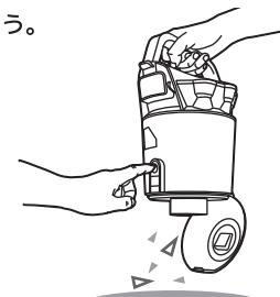
ゴミ箱の上でダストカップ底フタのロックを解除し底フタを開きダストカップ内のゴミを落としてください。
