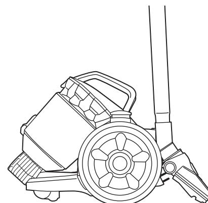
本体の電源を切り、フロアノズルのフック部分を本体ホルダーに差し込みます。
