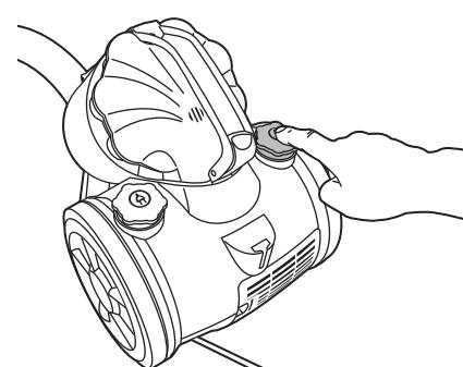
本体の電源ボタンを押します。吸引が開始されます。
