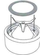
※ミキサーパッキンがないと内容物が漏れますので必ず取り付けてください。
