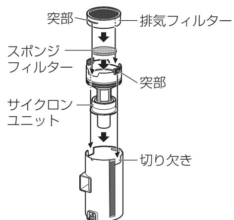
※サイクロンユニットの突部をダストカップケースの切り欠きに合わせて、真っすぐ奥までしっかりと取り付けてください。
