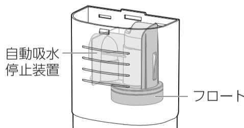
※気泡などにより満水になる前に自動吸水停止装置のフロートが動作する場合があります。
