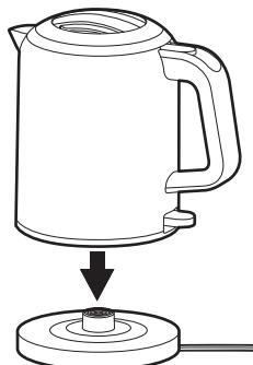
※電源プレートの中央に正しくセットしないと、電源が入らないだけでなく、ななめになったり、転倒したりして周囲の水ぬれの原因になります。
