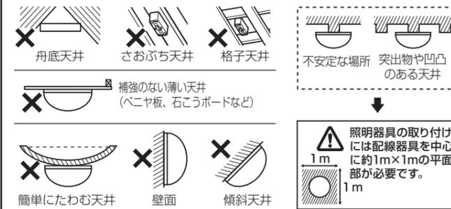
照明器具の取り付けには配線器具を中心に約1m×1mの平面部が必要です。
