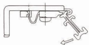
（ブラケットは天井付けの場合、天井面又はレールに先に取り付けてもOKですが、正面付けの場合はブラケットを先に壁面に取り付けてから、レールを取り付けて下さい。）
