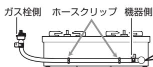
機器側のホースエンド（ゴム管口）はガス栓の位置によって向きを変えられます。
