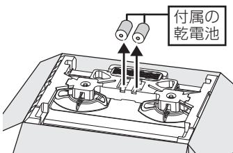
電池交換サインが点滅していたら…乾電池の交換時期です。
