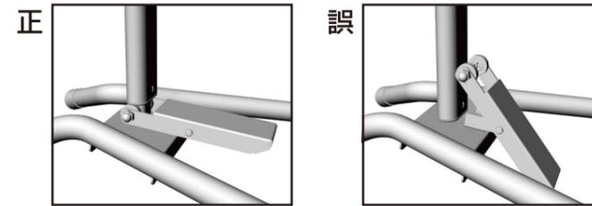
4. ポンプ台にポンプを設置してください。まず、プレート固定ツマミを向かって反時計回りに回し、プレートを緩めます。プレートが回るようになりますので、ポンプ台にポンプを置いてください。ポンプの頭とプレートの位置を合わせ、プレート固定ツマミを時計回りに回してプレートをしっかりと固定してください。
