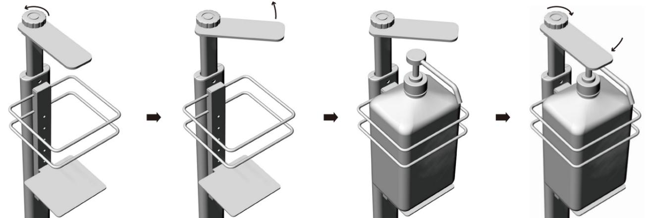
5. ポンプの頭とプレートの位置を調節してください。ペダルを踏んでいない状態で、ポンプの頭とプレートの間隔ができるだけ小さくなるようにポンプ台の位置を調節してください。ただし、ペダルが床につくまで踏み込んだ時にポンプが上昇する高さは 22mm で固定です。ポンプの頭が下降できる長さはご使用になるポンプによって異なりますので、ペダルを実際に踏んで使いやすい高さにポンプ台の位置を変更してください。
