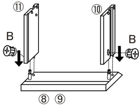
10・11、14・15に注2の様に矢印に注意しBをはめ込みます。溝をあわせて10・11を8・9に、14・15を13に差し込み、注3の様にBを回して固定します。
