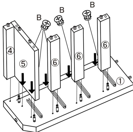
5と6(三枚)に矢印に注意してBをはめ込みます。2を差し込み、Bを回して固定します。
