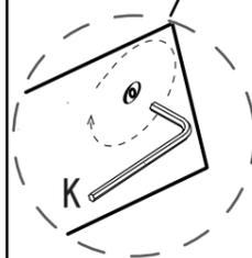
※引き出しボルト受けの深さにより引き出しストッパーが効かない場合は付属しているK六角レンチを使用しボルト受けを回して深さの調整をお願いします。
