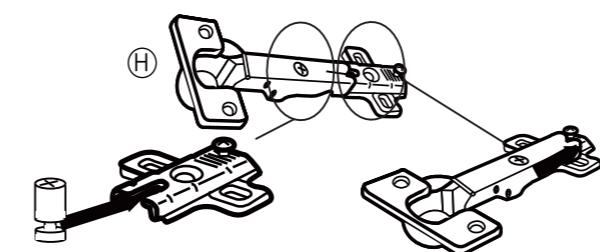
この部分に付いているボルトの細くなっている箇所が、側板側のくぼみにはまるようにします。
