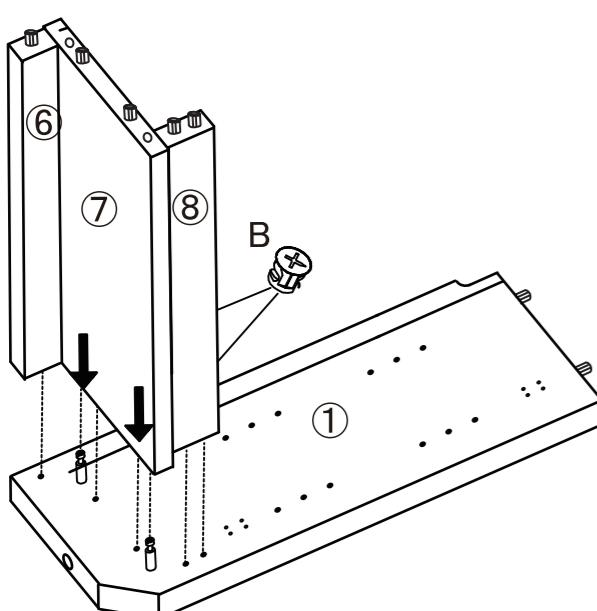
7の穴に矢印に注意してB受けをはめ込み、2をのせてBを回して固定します。
