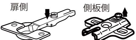
上の図のそれぞれのネジを矢印の方向へ扉側はねじ込み、側板側は出します。
