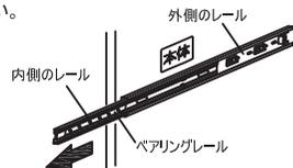
⚠注意 スライドレールを取り付ける際は、必ず本体内側のレールから「ベアリングレール」を取り出した状態にしてください。
