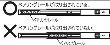
2 引き出したベアリングレールに、スライド部(引き出し、スライド棚など)のレールを3cmほど左右均等に差し込みます。
