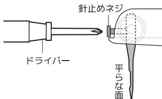
2 針の平らな面を本体の正面に向けて差し込み、ネジを締める
