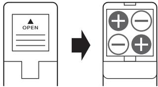
本体底面部の電池ボックスのフタを開けて、新しい単三形乾電池4本（別売）をセットします。
