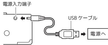
USBケーブルを電源入力端子に差し込みUSB接続のできる電源へ接続します。
