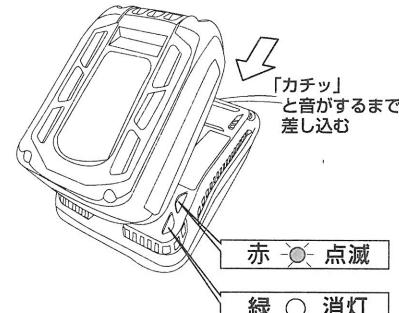
3. 約 90 分間で充電が完了すると、緑ランプが点灯して、赤ランプが消灯します。充電が完了したら、リリースボタンを押してスライドさせてバッテリーパックを充電器から取り外してください。
