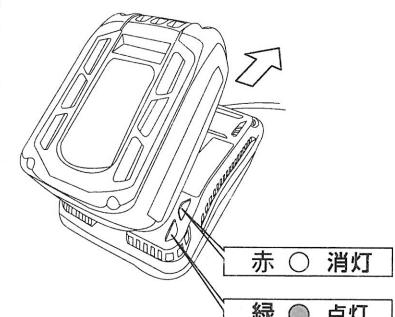
4. 充電が完了したら、必ず充電器の電源プラグをコンセントから抜いて、風通しの良い場所で十分に熱を冷ましてください。
