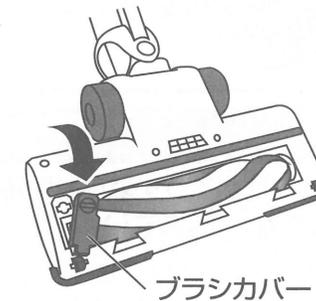
③ ブラシカバー側から抜き取り、回転部を取り外します
