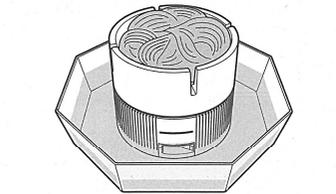
5. そうめんトレーを反時計方向に回して電源をONにしてください。水流が発生します。
