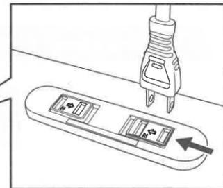
電源プラグを差し込む際は、差し込み口を矢印の方向にスライドさせながら差し込んでください。
