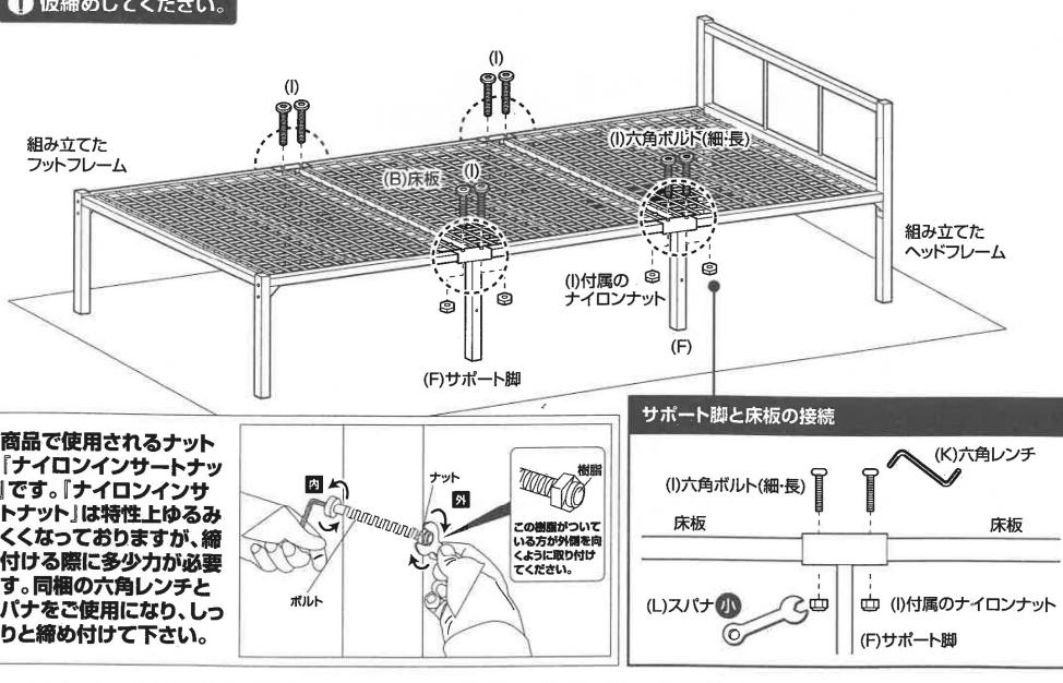
当商品で使用されるナットは「ナイロンインサートナット」です。「ナイロンインサートナット」は特性上ゆるみにくくなっていますが、締め付ける際に多少力が必要です。同梱の六角レンチとスパナをご使用になり、しっかりと締め付けて下さい。
