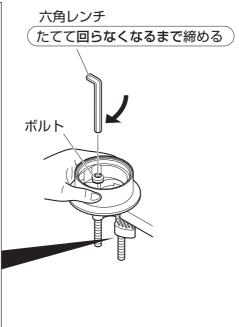
(5) 六角レンチを横にして左右両方のボルトを一回転増締めして上取付フランジを確実に固定してください。
