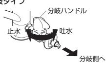
通水状態や本体内部に圧力がかかっている場合、給水ホースを取付ける事ができません。 給水ホースを取付ける事ができない場合は、安全装置を復帰してください。参照:P15
