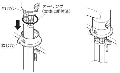
(3) 止めねじで本体を確実に固定し、ビスキャップ でねじ穴をふさいでください。
