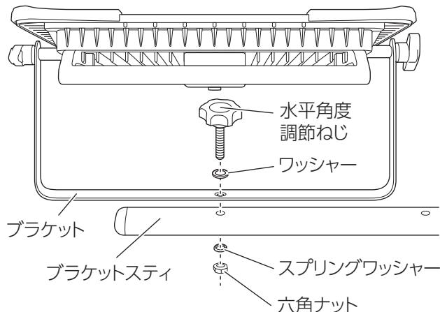
3. スタンドの本体受け金具中央の穴に、ブラケットスティ・ジョイントケース金具・ワッシャー・スプリングワッシャー・水平角度調節ねじの順に取り付け、固定してください。
