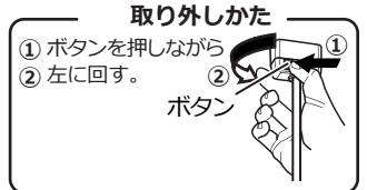
確認 取付け後、ボタンを押さずに左に回して、外れないことを確認する。
