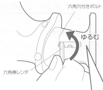
2.ブレード押さえ金具を持ち上げ、ブレードホルダーベースとの間にすき間をつくりください。
