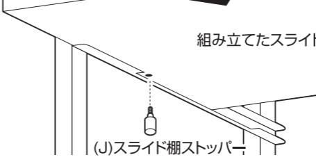
② 組み立てたスライド棚を本体に差し込み、スライド棚ストッパーを取り付けます。
