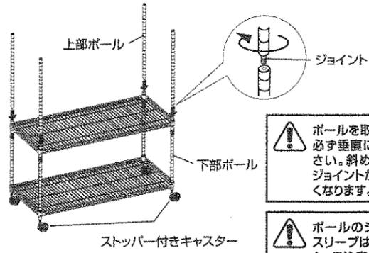
⚠ ボールを取り付けるときに、必ず垂直に取り付けてください。斜めに取り付けるとジョイントがボールに入らなくなります。
