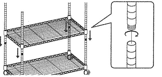
⚠️ 上部ポールを取り付けるときに、必ず垂直に取り付けてください。斜めに取り付けるとジョイントがポールに入らなくなります。
