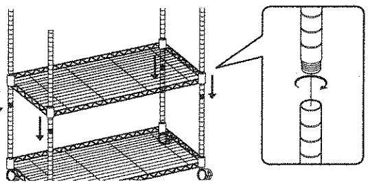
⚠️ 上部ポールを取り付けるときに、必ず垂直に取りつけてください。斜めに取り付けるとジョイントがポールに入らなくなります。
