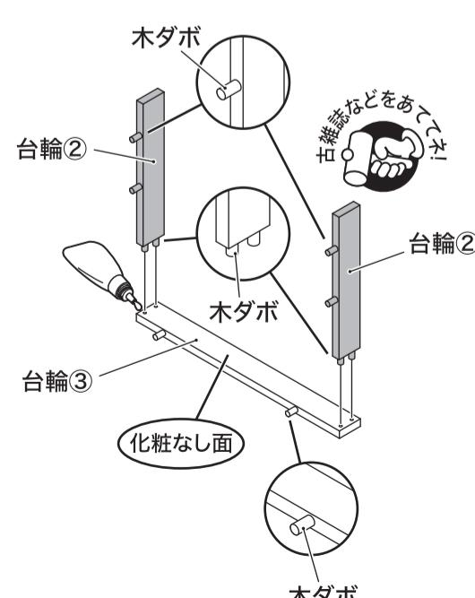
**14** ⑩で組み立てたものに ⑫で組み立てたもの、⑬で組み立てたものを取り付けます。
