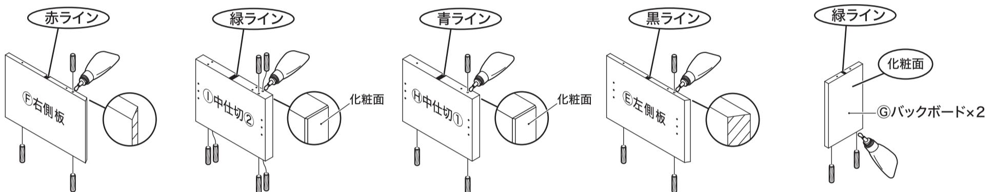
**5 3** で組み立てたものに左右側板、中仕切①、中仕切②、バックボード(×2)を取り付けます。
