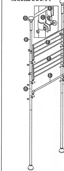
④ハンガーを取り付け、高さ調整をします。
