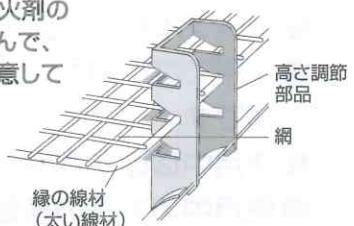
④火がおきて火力が安定したら、網の縁の線材(太い線材)が下になるように網を高さ調節部品にしっかりと差し込みセットしてください。
