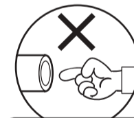
パイプ切断面に注意!
