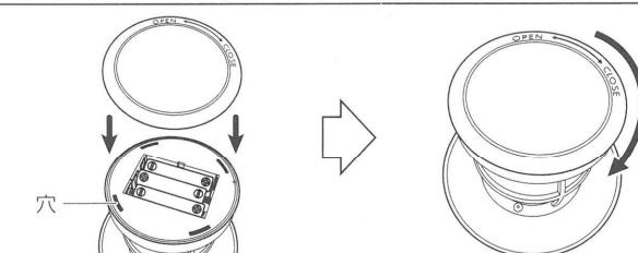
3. 乾電池が正しくセットされていることをご確認後、電池カバーの裏の爪を本体の穴にあわせてはめ込み、矢印の方向に回して、止まるまで閉めてください(図3)。
