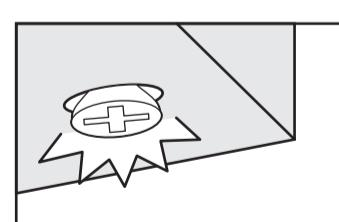
**ネジ締めが緩く、ネジが出ていると床面を傷つけてしまう恐れがあります。**
