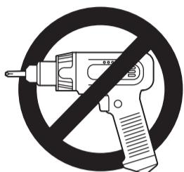
**電動工具を使用するとネジや部材が破損する恐れがあります。**
