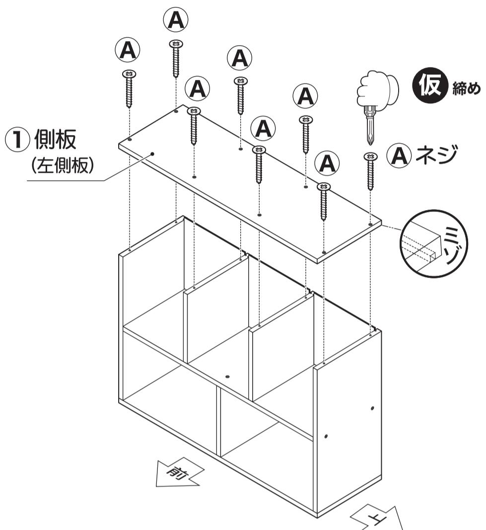
**8** 本体を起こし、仮締めしておいたネジをしっかりと締め直し、ネジ留め箇所に②ネジ隠しシールを貼って完成です。
