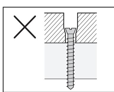
**回しすぎ、入れすぎにご注意ください。**
