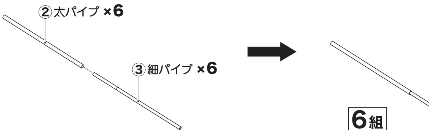
2 ① フレーム × 2 に 1 でセットしたパイプ × 6 を取り付けてください。
