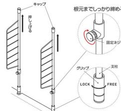
※圧着固定をする際、支柱が一緒に回ると、適正な圧着固定ができませんので、支柱が回らないように支えて、グリップを回してください。
