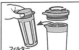
①ネジ栓を反時計回りに回転させてフィルターを取り外す。
