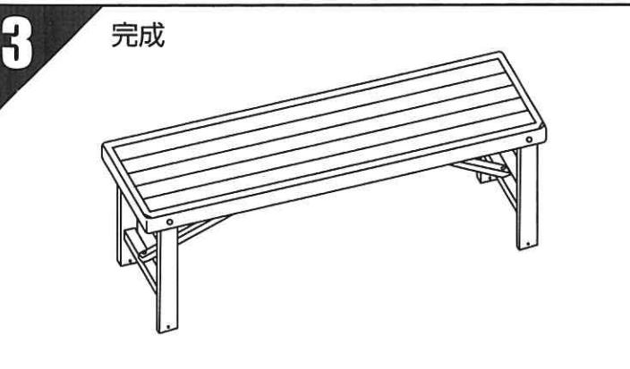
使用時寸法(約):幅1200×奥行き390×高さ400(mm)
