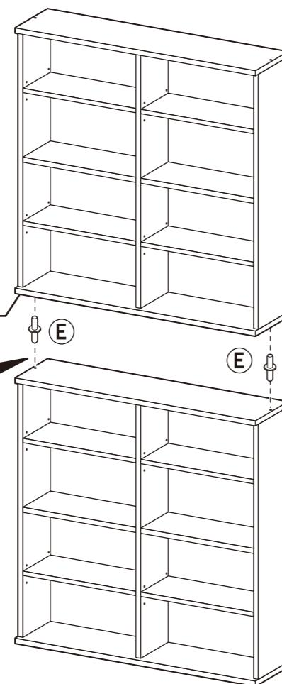
下置きの天板の穴に接続ピンを差し込み、上置きの地板の穴にきっちりと差し込んで積み重ねてください。
