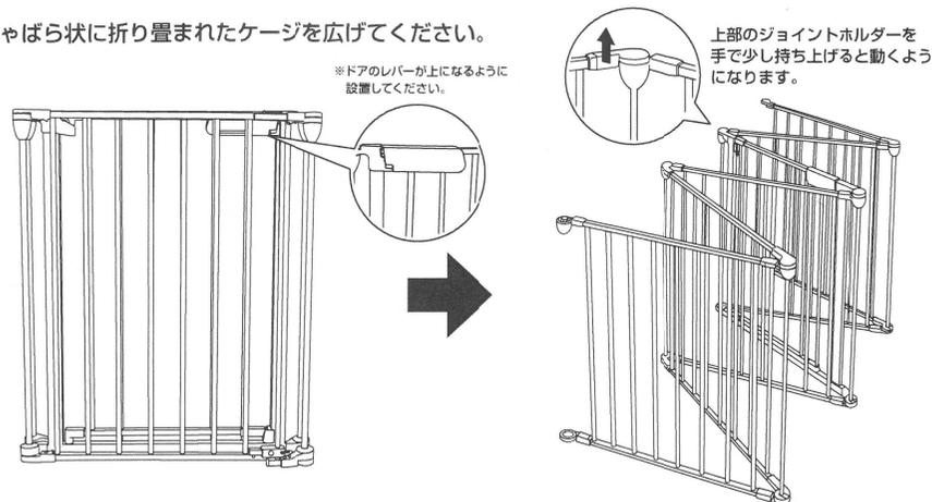
**2** ケージを図のように設置してください。ジョイントパーツの位置を調整することで、長方形の他、六角形などお好きな形に設置が可能です。
