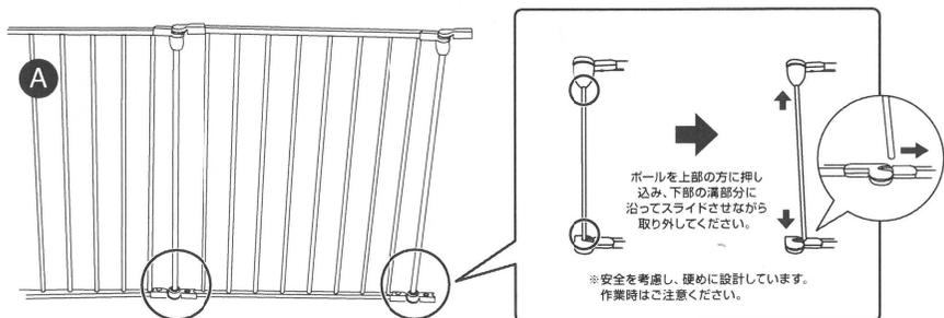
**2** 不要な面を取り外した後、ジョイントホルダー同士を組み合わせ、ジョイントホルダーにボールを差し込んで固定してください。
