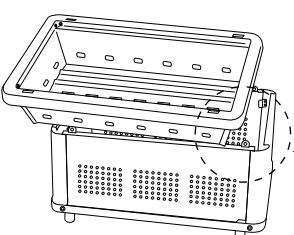
穴の位置を合わせて串焼スタンドの取付穴が出るようにしてください。
