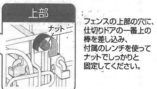
フェンスの上部の穴に、仕切りドアの一番上の棒を差し込み、付属のレンチを使ってナットでしっかりと固定してください。
