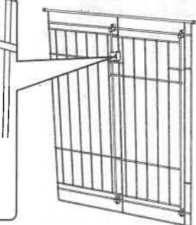
図のようにドアロックを回転させることで、ロックができます。(開閉どちらの状態でもロックができます。)
