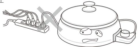
交流100V以外で使ったり、コンセントを他器具と併用したり、延長コードを使うと火災・感電の原因になります。
