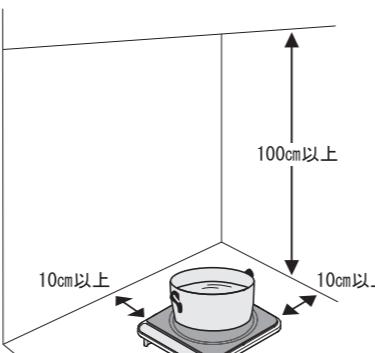
製品を10cm以上壁より離さないと十分な内部冷却が出来ずに安全装置が働く場合がありますのでご注意下さい。
